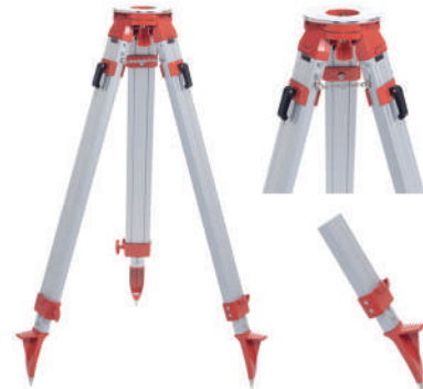
SJA 60 Alüminyum Total Station Sehpası Alüminyum Kitleme Sistemi : Mandallı ve Vidalı Sehpa Açık Uzunluk: 166 cm Sehpa Kapalı Uzunluk: 103cm Ağırlık: 4.8 kg Stok Kodu: 020-270
