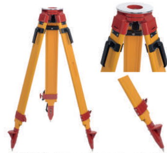
ST 2005 Ahşap Fiberglas Total Station sehpa Ahşap - Fiberglass Kitleme Sistemi: Vidalı ve Mandallı Sehpa Açık Uzunluk: 179 cm Sehpa Kapalı Uzunluk: 113 cm Ağırlık: 7.5 kg Stok Kodu: ST2005
