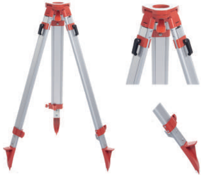
SJA 40 Alüminyum Nivo ve Teodolit Sehpası Alüminyum Kitleme Sistemi: Mandallı ve Vidalı Sehpa Açık Uzunluk: 170 cm Sehpa Kapalı Uzunluk: 107 cm Ağırlık: 4.4 kg Stok Kodu: 020-271
