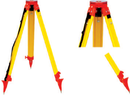
SJW 20 Ahşap Nivo ve Teodolit Sehpası Ahşap Kitleme Sistemi: Vidalı Sehpa Açık Uzunluk: 171 cm Sehpa Kapalı Uzunluk: 103 cm Ağırlık: 4.5 kg Stok Kodu: 020-250
